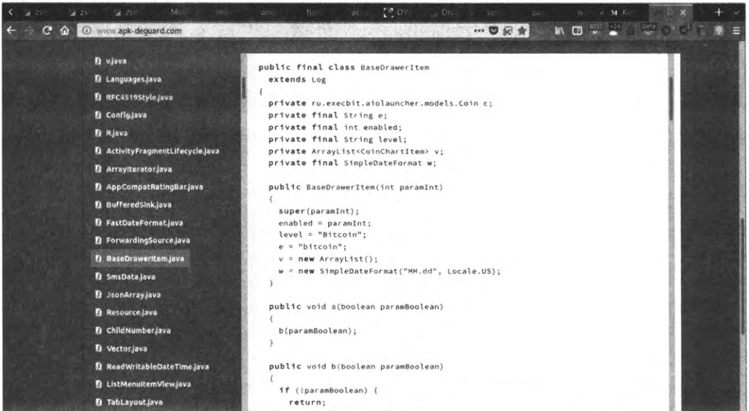
Рис. 11.4. Пример деобфускации с помощью DeGuard
